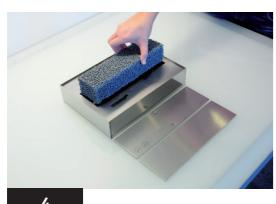
coloque la placa de cerámica en la cámara de combustión.
