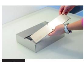
coloque las tapas correderas sobre la cámara de combustión con los orificios hacia fuera. la tapa corredera sin orificios debe encontrarse en su lado opuesto.
