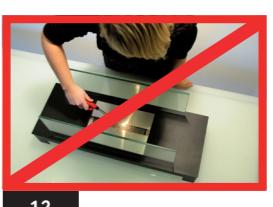
steek de brandkamer nooit van bovenaf, maar altijd van opzij aan. blijf altijd op veilige afstand! voorzichtig, de brandkamer kan met een plafondje van steekvlam ontbranden!
