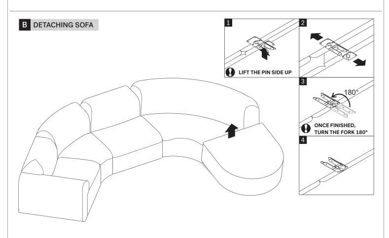
LIFT THE LEFT SIDE OF THE SEAT TO DETACH THE CLIPS AND DISCONNECT THE ITEMS
